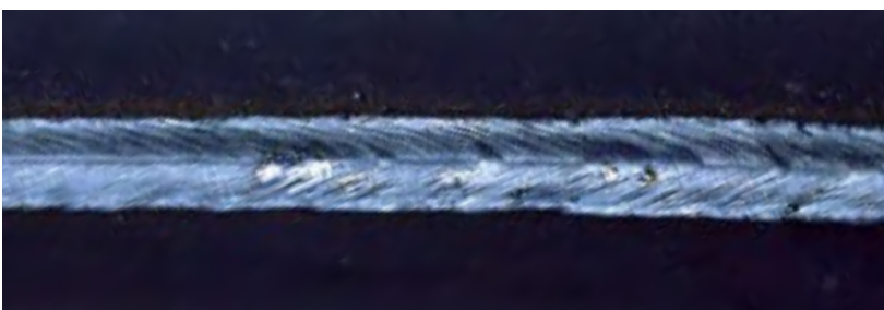
Přepřátovaný svar v režimu SSA™; 2mm tloušťka; 1,2m/min.
